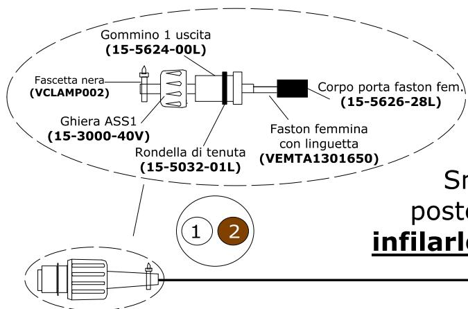
Smontare il coperchio di plastica sul 3° stop svitando le viti poste nella parte posteriore. Togliere la protezione dal 3° stop e **infilarlo nell'apposita sede prima di cablare il connettore 2 poli**
